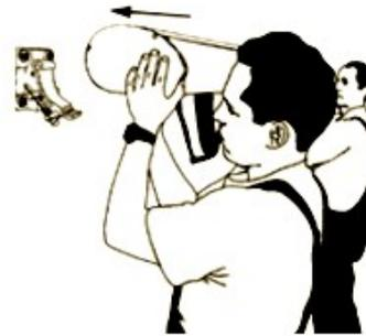
11) Fixez la poutre de structure du store avec des vis.
