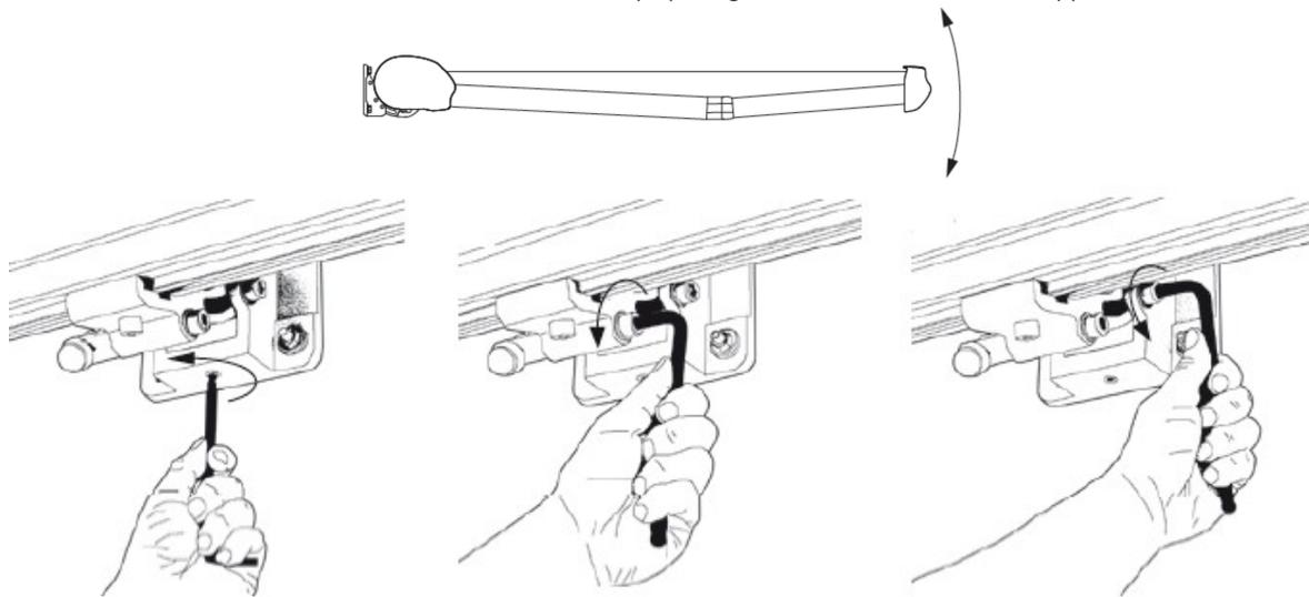
16) Dévissez consécutivement à la clé la vis de réglage à tête hexagonale (pour diminuer l'angle d'inclinaison) ou vissez (pour augmenter l'angle d'inclinaison).
