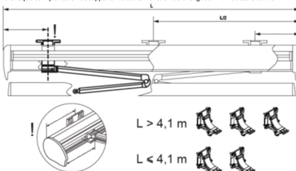
**Les supports muraux doivent être montés à l'endroit indiqué par le constructeur à l'arrière de la cassette (afin qu'ils soient « sur l'axe » symétrique de supports des bras).**
