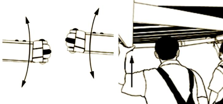
14) Si nécessaire, ajustez le niveau des bras en dévissant ou en serrant la vis interne M5 dans les supports des bras.
