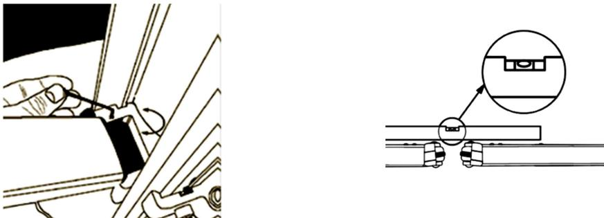
15) Pour modifier le réglage de l'angle d'inclinaison du store banne déroulez complètement le store banne, et puis desserrez à la clé la vis interne et les vis à tête creuse M10 qui protègent l'élément amovible de supports muraux.
