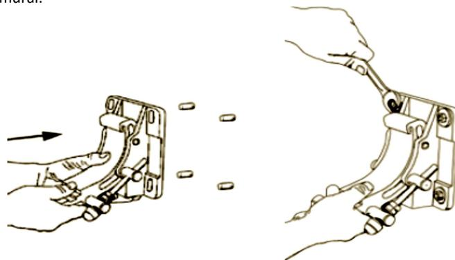
6) Sur la base du support mural monté (base), déterminez les points de fixation d'autres supports - faites particulièrement attention à ce que les supports muraux montés soient dans un même niveau et dans un même plan.
